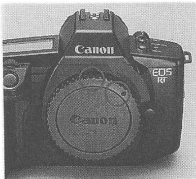
**2** ボディキャップを矢印方向に回して外します。
