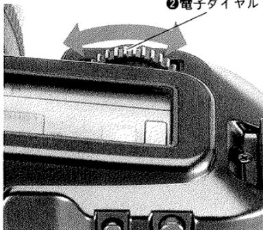
2 各モードを表す数字がフィルム枚数計に表示されます。電子ダイヤル②を回すごとに数字は増えていきます。希望するイメージの数字を選びます。
