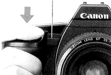
4 シャッターボタンを半押ししてピントを合わせ、そのままさらに深く押します。セルフタイマー表示ランプ⑤が点滅を始め、撮影は約10秒後に行われます。なお、撮影2秒前になると点滅が速くなります。また、表示パネル上に撮影までの残り時間が表示されて行きます。
