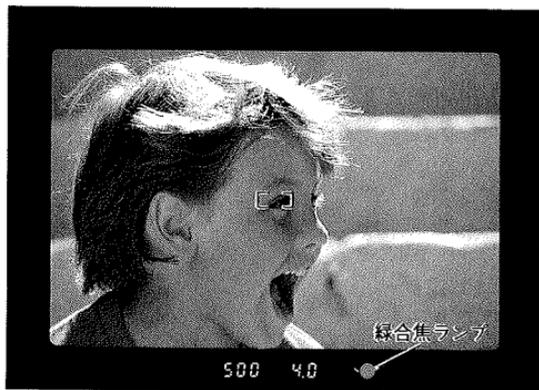
2 シャッターボタンを半押しして撮りたいものにピントを合わせます。ピントが合うとファインダー内右下の緑合焦ランプが点灯します。
