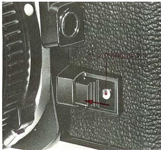
4.絞込みレバーの下のロック解除ボタンを押して絞込みを解除します。
