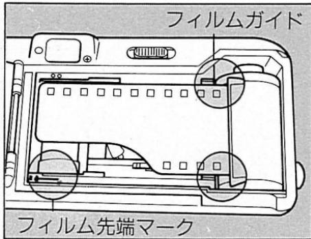
3 フィルム先端を、フィルム先端マークまで引き出します。
