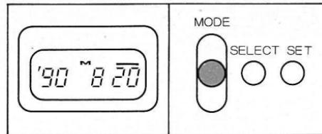
1 データ表示切り替えボタン(MODE)を押して、表示パネルに修正する日付(時刻)を表示します。
