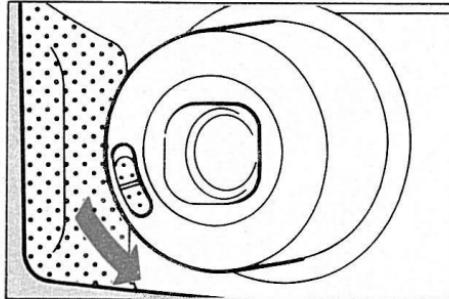
1 レンズカバー開閉ノブを矢印方向にスライドさせてレンズカバーを開けます。
