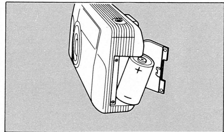
2  $\oplus\ominus$ の表示を正しく合わせ、電池を図のような向きで入れ、電池室蓋を閉じます。
