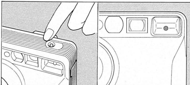
カメラを被写体に向けて構図を決め、セルフタイマー ボタンを押してピントを合わせます。ピントが合うと緑ランプが点灯します。
