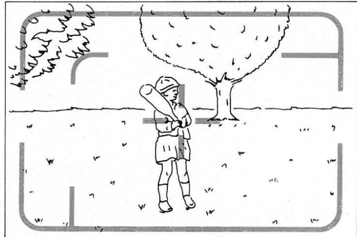
2 ピントを合わせる被写体にフォーカスマスクを合わせ、軽くシャッターボタンを押します。緑ランプが点灯してピント合わせが完了します。
