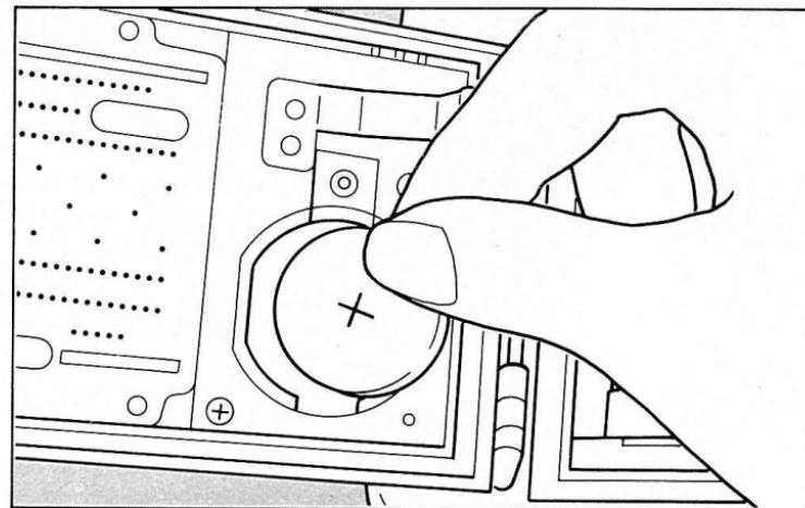
3 新品電池の+を上にして入れ、電池室蓋を取り付けます。
