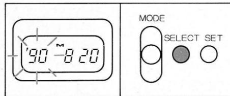
2 修正位置選択ボタン(SELECT)を押して修正する数字を点滅させます。
