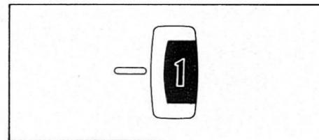
フィルムが正しくセットされると、フィルムカウンターに“1”が表示されます。
